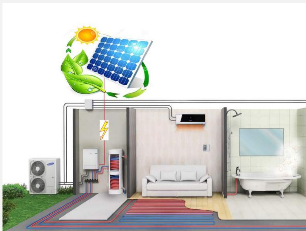
**La produzione dell'acqua calda per il riscaldamento degli ambienti è garantita da una pompa di calore alimentata dall'impianto fotovoltaico condominiale.**
